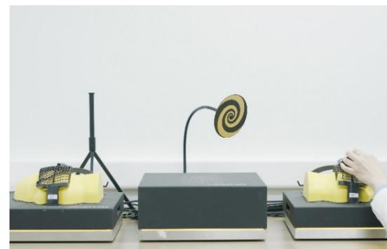
Fast SAR 측정 시스템
