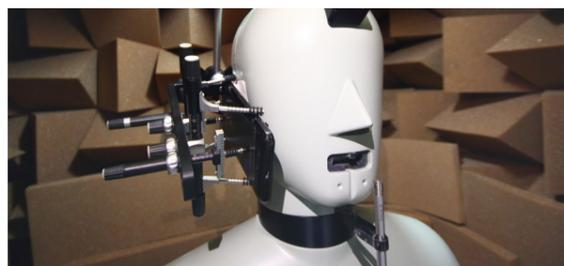
음압 레벨테스트 시스템 Sound Pressure Level Test System
